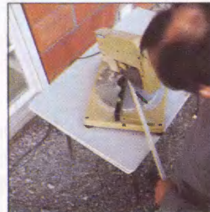
Из двух стыкуемых профилей сначала устанавливаем тот, у которого более острый угол (< 45°).
